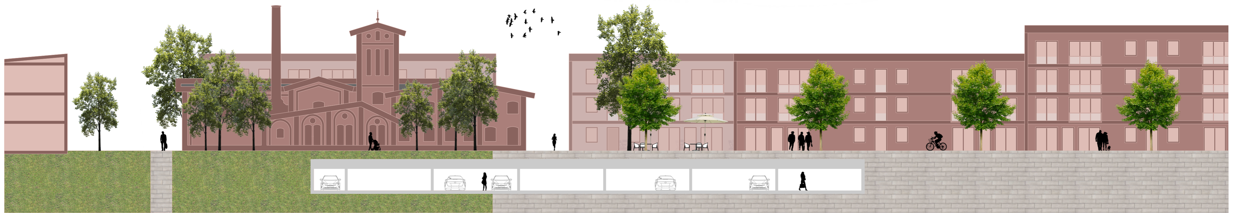
Schnitt A-A' durchs Quartier mit Tiefgarage M 1:200
